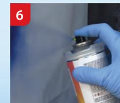
6 Ponga la lata en posición vertical y realice una prueba de pulverización.
